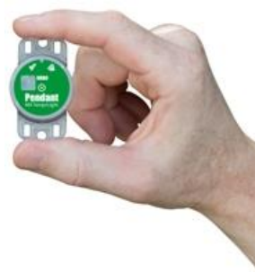
HOBO MX ペンダントロガー MX2202 パシコ貿易株式会社 HP より写真引用
